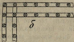
Рис. 3. Какъ забиваютъ кольца въ отверстия, просверленные въ доскахъ.
